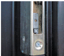
Abb. 11.3: Reed-Kontakt an einem Fenster zur Meldung des Öffnungsstatus.
