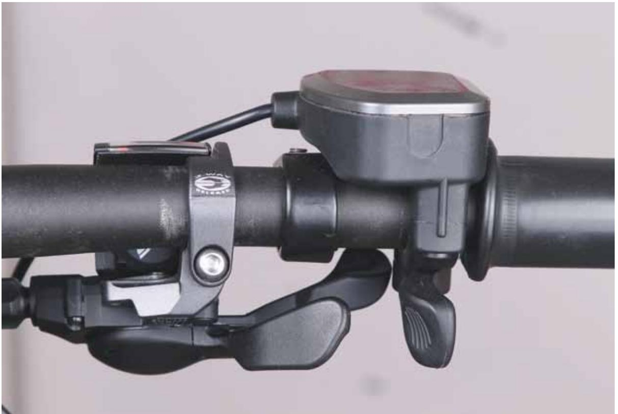
Abb. 6.8 – Platzprobleme bei Drehgas und Daumengas.
