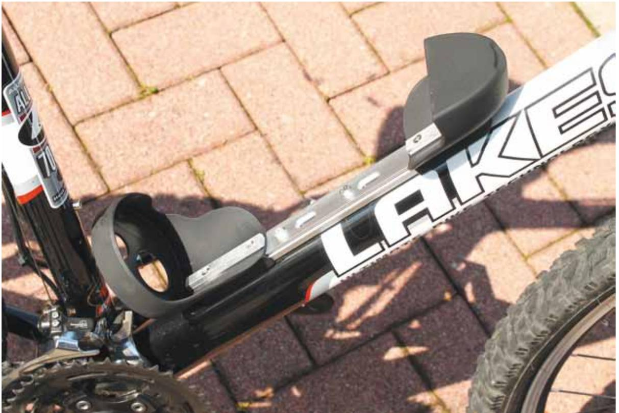
Abb. 6.1 – Trinkflaschenakkus werden an den Aufnahmehaltern für die Trinkflaschen angebracht.
