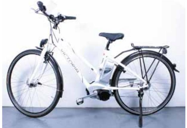
Abb. 1.1 – Ein typisches City-Pedelect mit Mittelmotor.
