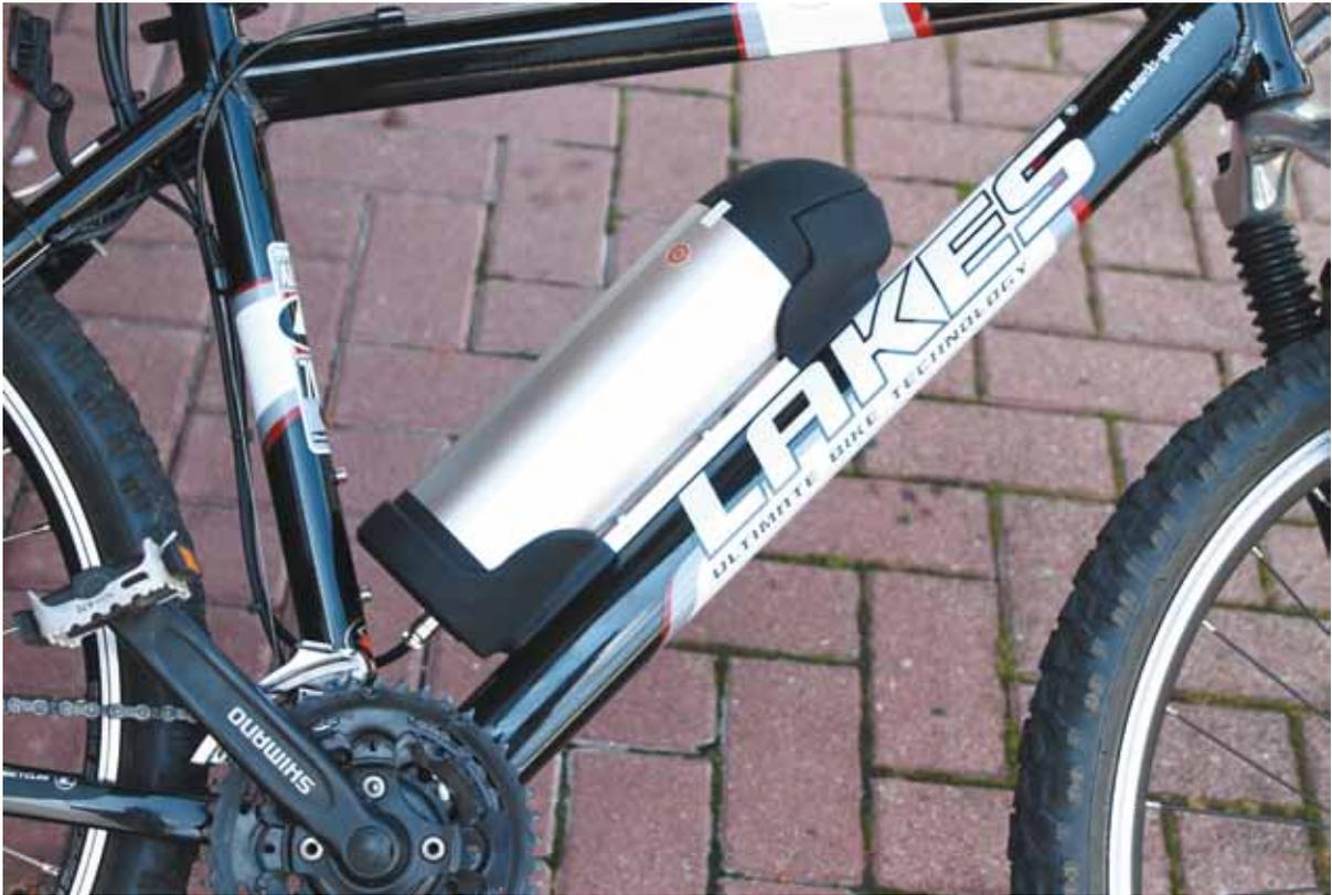
Abb. 6.2 – Ein eingebauter Flaschenakku.
