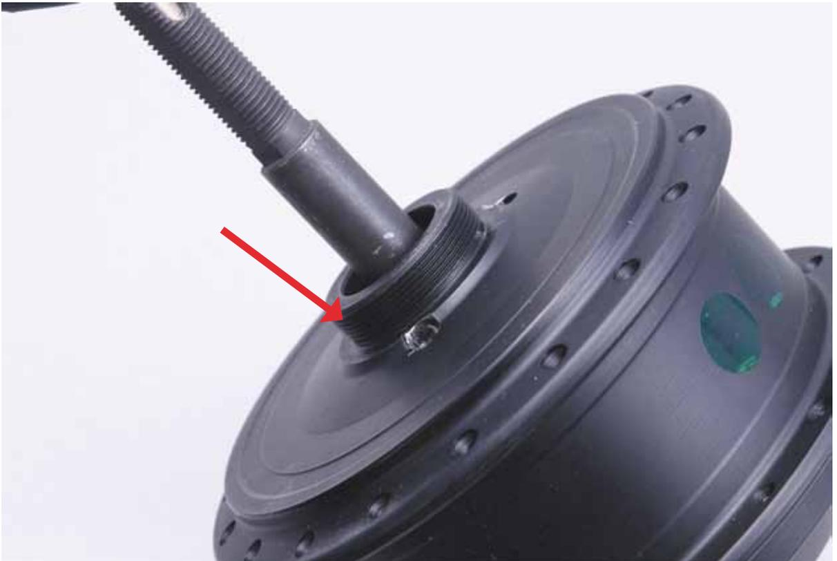
Abb. 6.10 – Feingewinde zur Aufnahme von Schraubkassetten.
