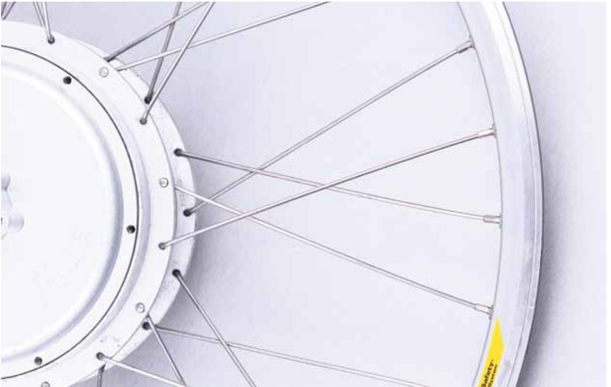
Abb. 6.15 – Hier ist deutlich der Knick in der Speiche unmittelbar nach der Verbindung zur Felge zu sehen.
