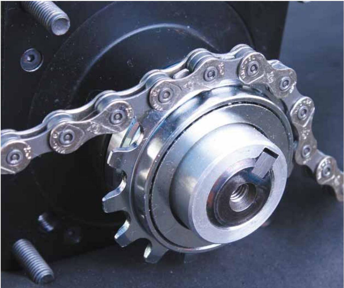
Abb. 6.11 – Antriebskette für den Kettenmotor.
