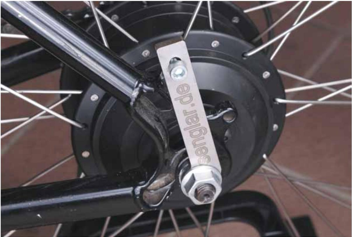
Abb. 6.20 – Clevere Lösung: Die Drehmomentstütze ist hier an der Aufnahme für die Bremse montiert.
