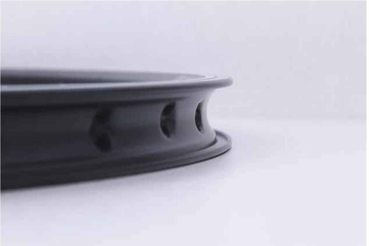
**Abb. 6.17** – Pedelec-Felgen sind am Felgenboden verstärkt, um die größeren Kräfte aufzunehmen.
