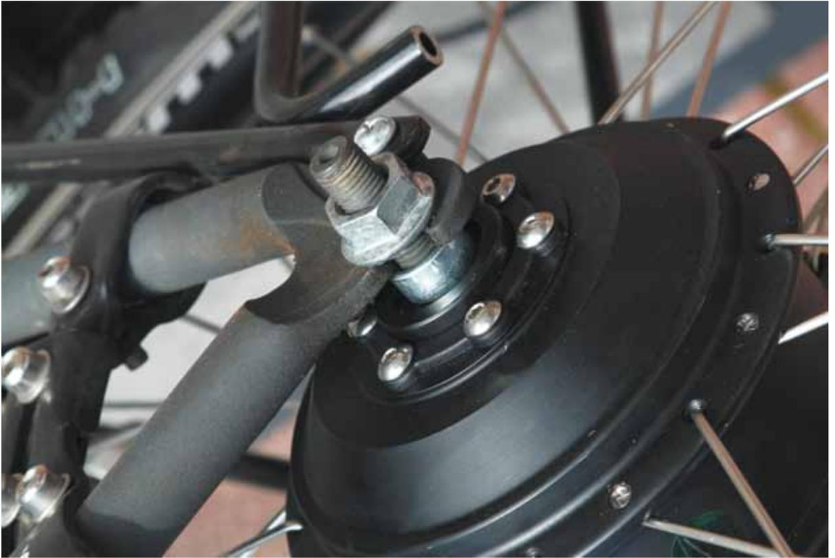
Abb. 6.19 – Achse in Ausfallende – ohne Drehmomentstütze wird sich die Achse in der Aufnahme bei großer Last mitdrehen.
