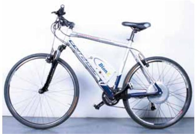
Abb. 1.3 – Auch Mountainbikes lassen sich zum Pedelec umrüsten, hier mit Hinterradnabenmotor.
