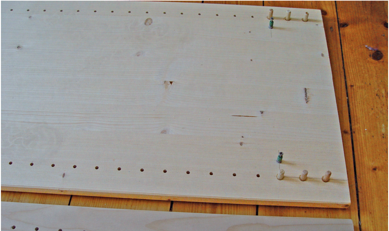
Abb. 4.9 – Die Seitenteile sind fertig zur Montage der Regalböden und Sockelleisten.
