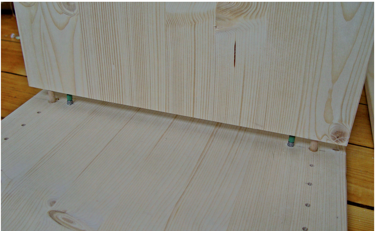
Abb. 4.10 – Der Regalboden wird auf das Seitenteil gesetzt und mithilfe der Exzenter-Verbindungsbeschläge fixiert.
