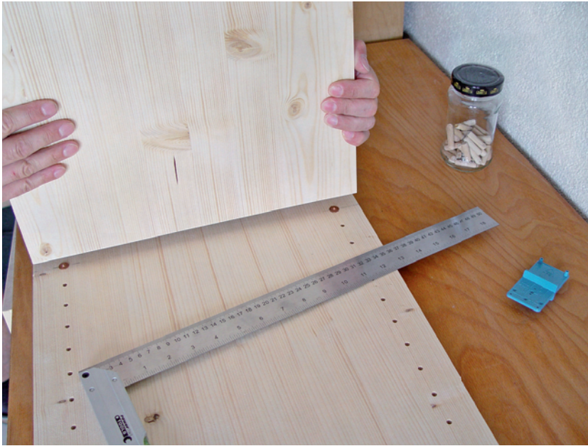
Abb. 4.5 – Der Regalboden wird gegen das Seitenteil gedrückt. Die Dübelfixe übertragen dabei die genaue Position der Dübel auf die Stirnseite des Regalbodens.
