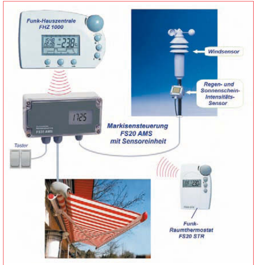
Abb. 3.24 – Eine vollautomatisch arbeitende Funk-Markisensteuerung FS20 AMS sollte zusätzlich auch mit einer witterungsgeführten Steuerung ausgerüstet werden, die bei stärkerem Wind oder aufkommendem Regen die Markise automatisch einfährt. Bei Bedarf kann auch ein Funk-Raumthermostat FS 20 STR den optimalen Zeitpunkt des Ein- und Ausfahrens der Markise mitbestimmen.
