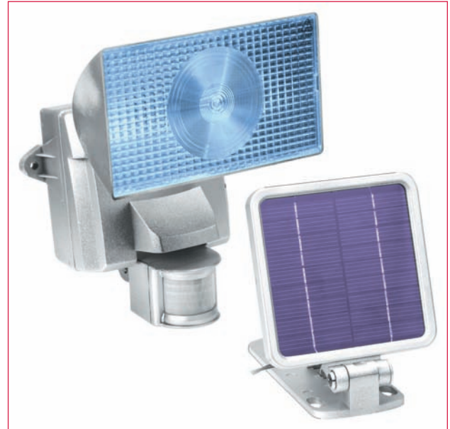
Abb. 2.9 – Ausführungsbeispiel eines solarbetriebenen 10-W-Halogenstrahlers, der als Bausatz mit einem leistungsstarken Solarmodul angeboten wird: Ein im Strahler integrierter Bewegungsmelder schaltet den Strahler für eine einstellbare Leuchtdauer ein (Foto/Anbieter: Westfalia).
