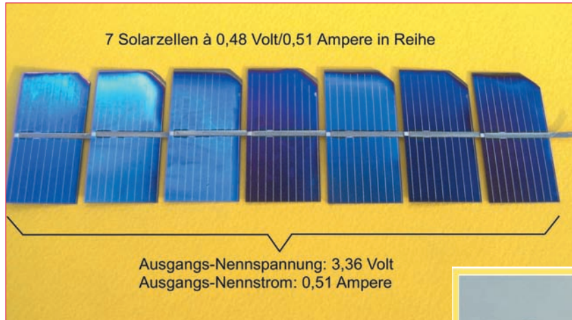
Abb. 2.20 – Die gewünschte Solarspannung wird einfach durch die passende Anzahl der Zellen in der Kette, der benötigte Solarstrom durch die Größe der Zellen bestimmt.
