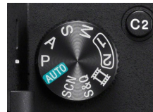
< Abbildung 1.5 Das Moduswahlrad ist die Programmschaltzentrale der α7 III.
