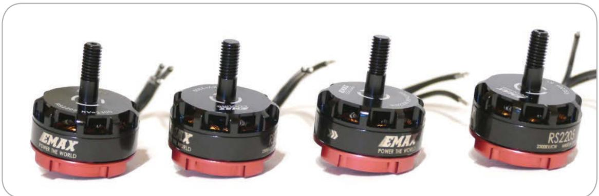
Heute kommen im Flugmodellbau und besonders im Multicopterbau fast ausschließlich bürstenlose Motoren, die sogenannten Brushlessmotoren, zum Einsatz.
