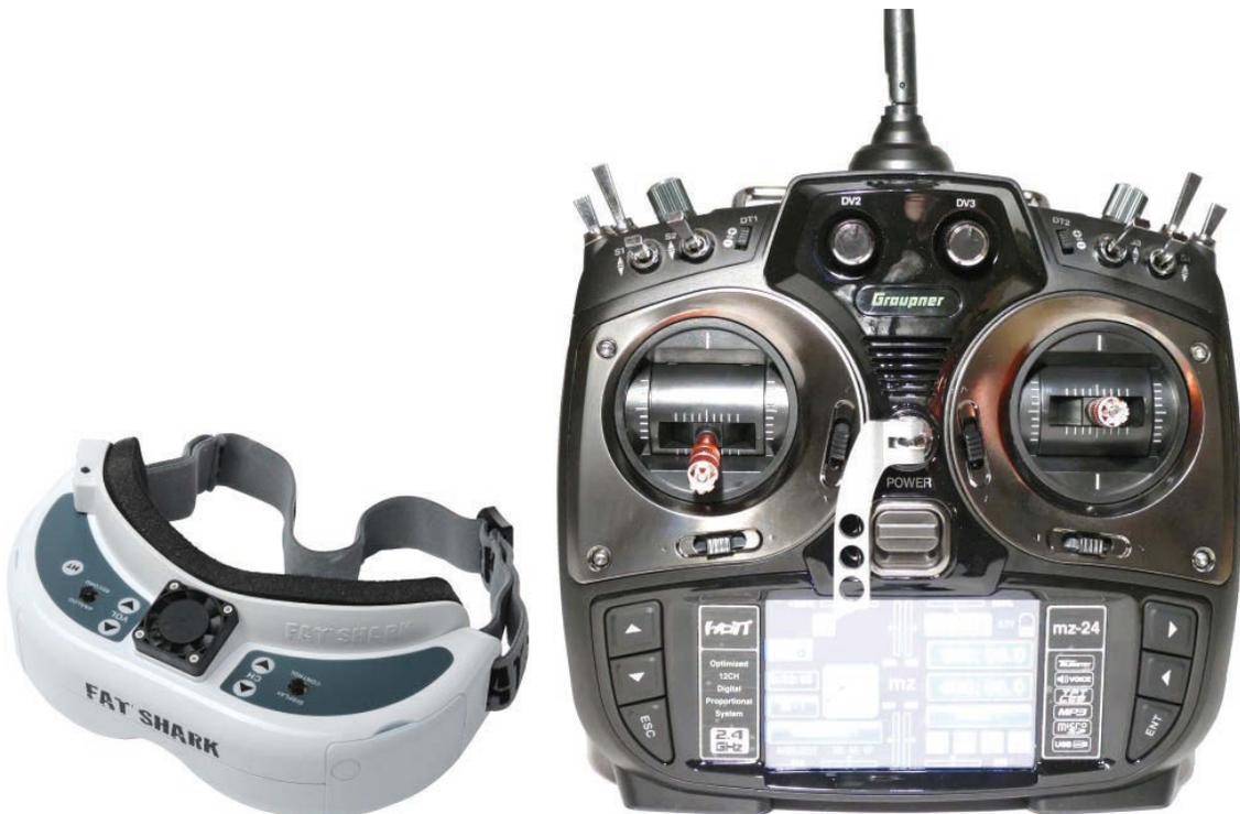
Der Pilot selbst benötigt noch eine FPV-Brille zum Empfangen des Videobilds und eine Fernsteuerung.
