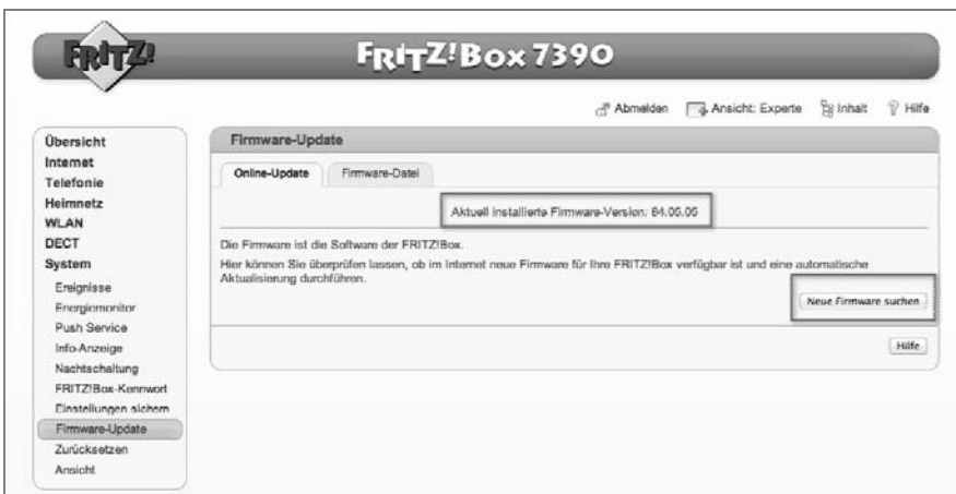
Bild 1.34: Freie Auswahl: Bei der FRITZ!Box können Sie die Firmware entweder über den AVM-Server (hier Schaltfläche Neue Firmware suchen ) oder über eine Firmwaredatei (Register Firmware-Datei ), die sich auf der Festplatte befindet, aktualisieren.
