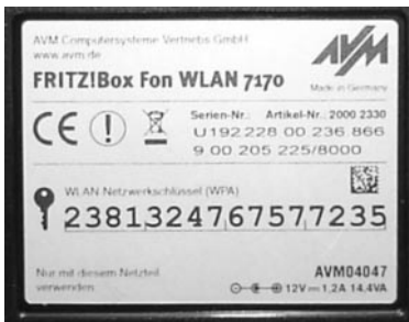
Bild 1.16: Neuere FRITZ!Box-Modelle sind ab Werk schon mit einem sicheren WPA2-Schlüssel vorkonfiguriert. Dieser befindet sich auf der Bodenplatte des Geräts.
