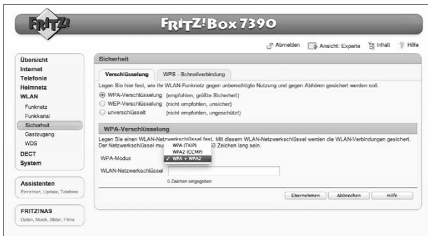
Bild 1.17: Die FRITZ!Box unterstützt mit WPA + WPA2 die derzeit aktuellste Verschlüsselung für WLANs. Lässt sich WPA2 bei einer betagten FRITZ!Box nicht auswählen, hilft in der Regel ein Firmware-Update, um die Box auf den aktuellen Stand zu bringen.
